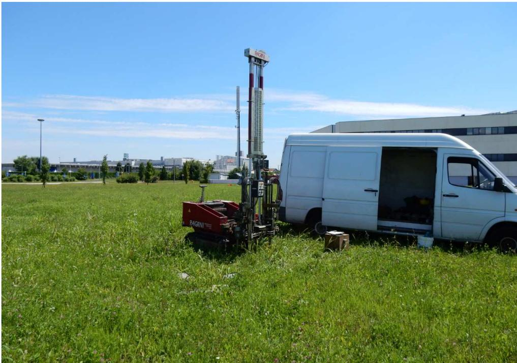
Foto 1: esecuzione della prova CPT01
