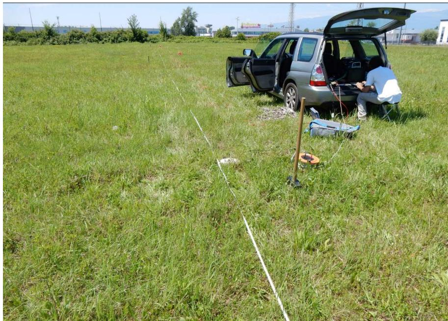
Foto 3: stendimento sismico MASW
